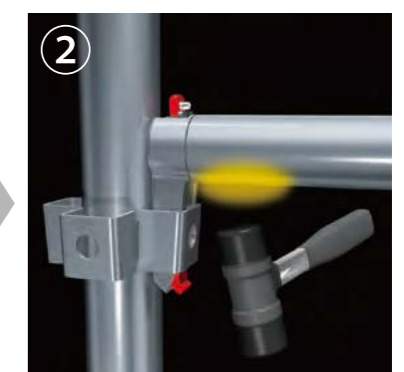
②手すりを叩き上げ、外す
